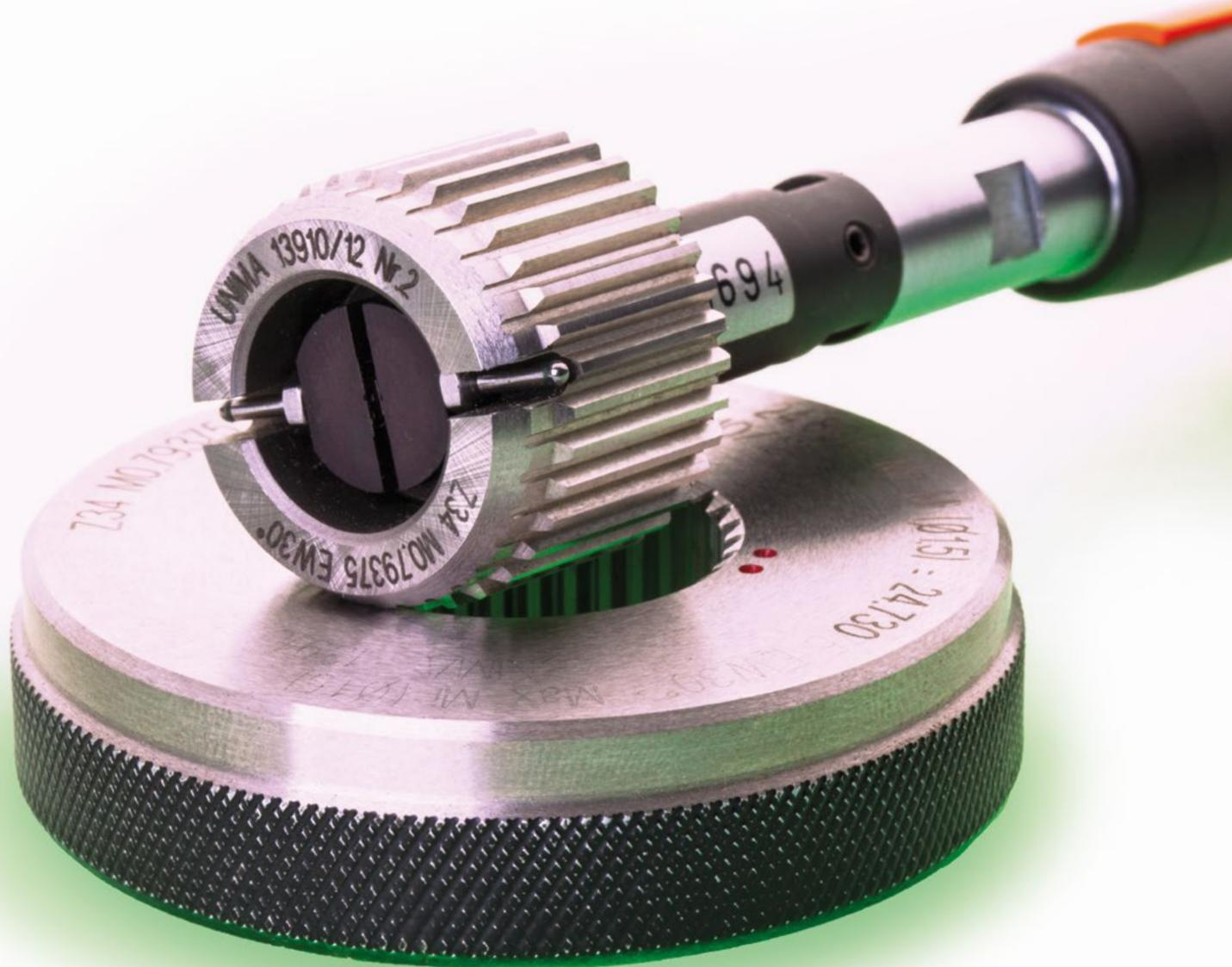
Die Zahn­lücken­weite / Zahndicke ist ein we­sentliches Merkmal zur Beurteilung von Ver­zahnungen. Messbar als diametrales Zwei­kugelmaß (Mdk-Maß) entscheidet sie maßgeblich über die Verbaubarkeit und Einsetzbarkeit ei­ner Verzahnung. Aus diesem Grund werden
