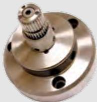
Keil-Spanndorne sind besonders geeignet zur Aufnahme von fußkreiszentrierten Innenverzahnungen bei der Werkstückbearbeitung. Sie bestehen aus einer Führungsverzahnung, in der radial verschiebbare Spannkeile eingelassen sind.
