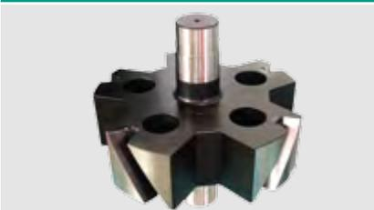
Hochgenaue Verzahnungsnormale werden zur Überprüfung bzw. Kalibrierung von Verzahnungsmessmaschinen eingesetzt.
