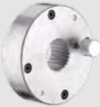
Der Rundlauf von Außenverzahnungen kann mittels der UNIMA-Rundlaufprüfringe schnell und unkompliziert geprüft bzw. gemessen werden. Rundlaufprüfringe werden auf die Außenverzahnung geschoben und über eine Rändelschraube aufgespannt.
