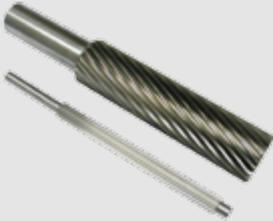
Konisch verzahnte Aufnahmedorne werden vorrangig für die Rund- und Planlaufprüfung an innenverzahnten Werkstücken verwendet.
